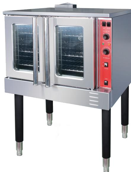
Pressions de gaz recommandées : GN, 6 po CE (14,9 mb), GPL 12 po CE (29,9 mb). Le régulateur de pression interne est réglé en usine pour un fonctionnement correct à une pression de 4 po CE (10 mb) pour le GN, et de 10 po CE (24,9 mb) pour le gaz GPL. La pression opérationnelle devrait être vérifiée et contrôlée lors de l'installation.
